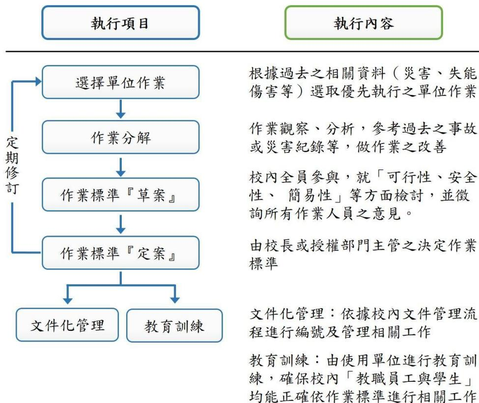
圖一 安全作業標準製作步驟
